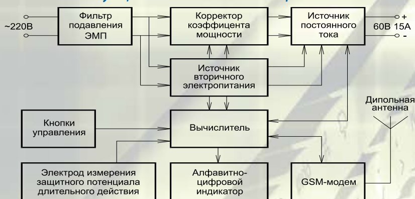
Функциональная схема СКЗ «ТВЕРЦА-900»
