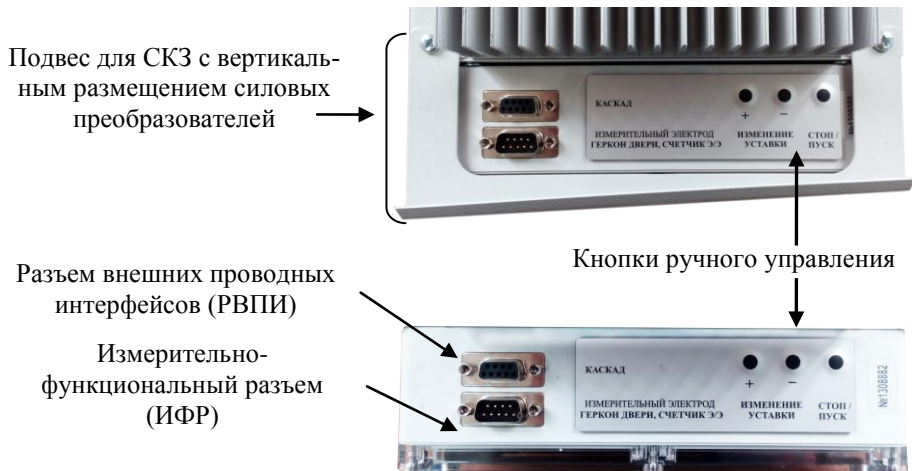
Рисунок 1.6 Размещение разъемов и кнопок управления на контроллере силового преобразователя
