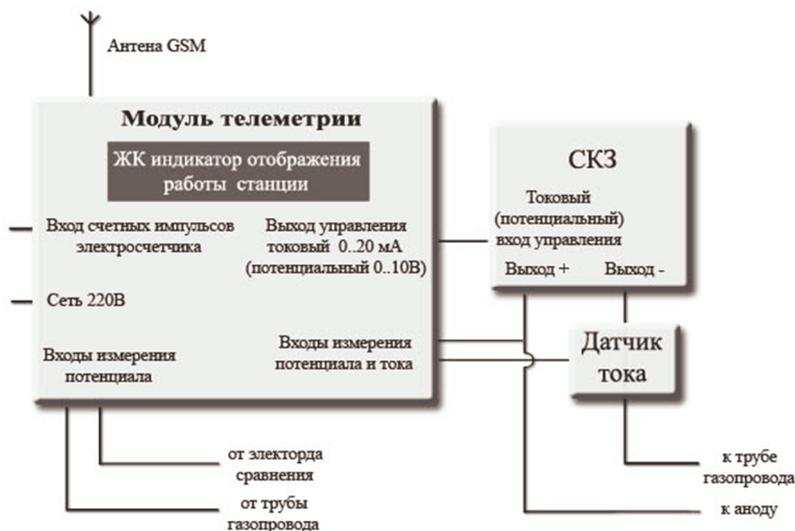
Схема подключения модуля телеметрии и телеуправления "Тверца-ТМ" к станциям катодной защиты с токовыми выходами управления
